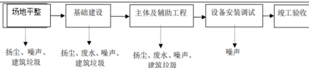
图2 本项目施工期工艺流程示意图
