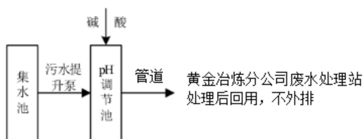
图 11 实验室废水处理设施工艺流程图
