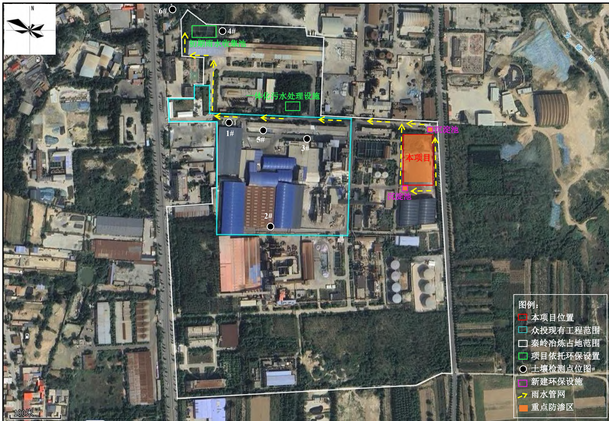
附图五 本项目拟采取的雨污分流措施、分区防渗及土壤现状监测点位示意图
