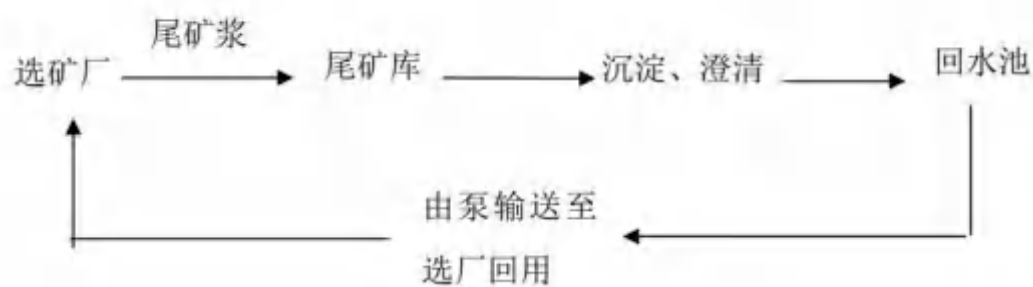
图 4-7 尾矿库工艺流程图
