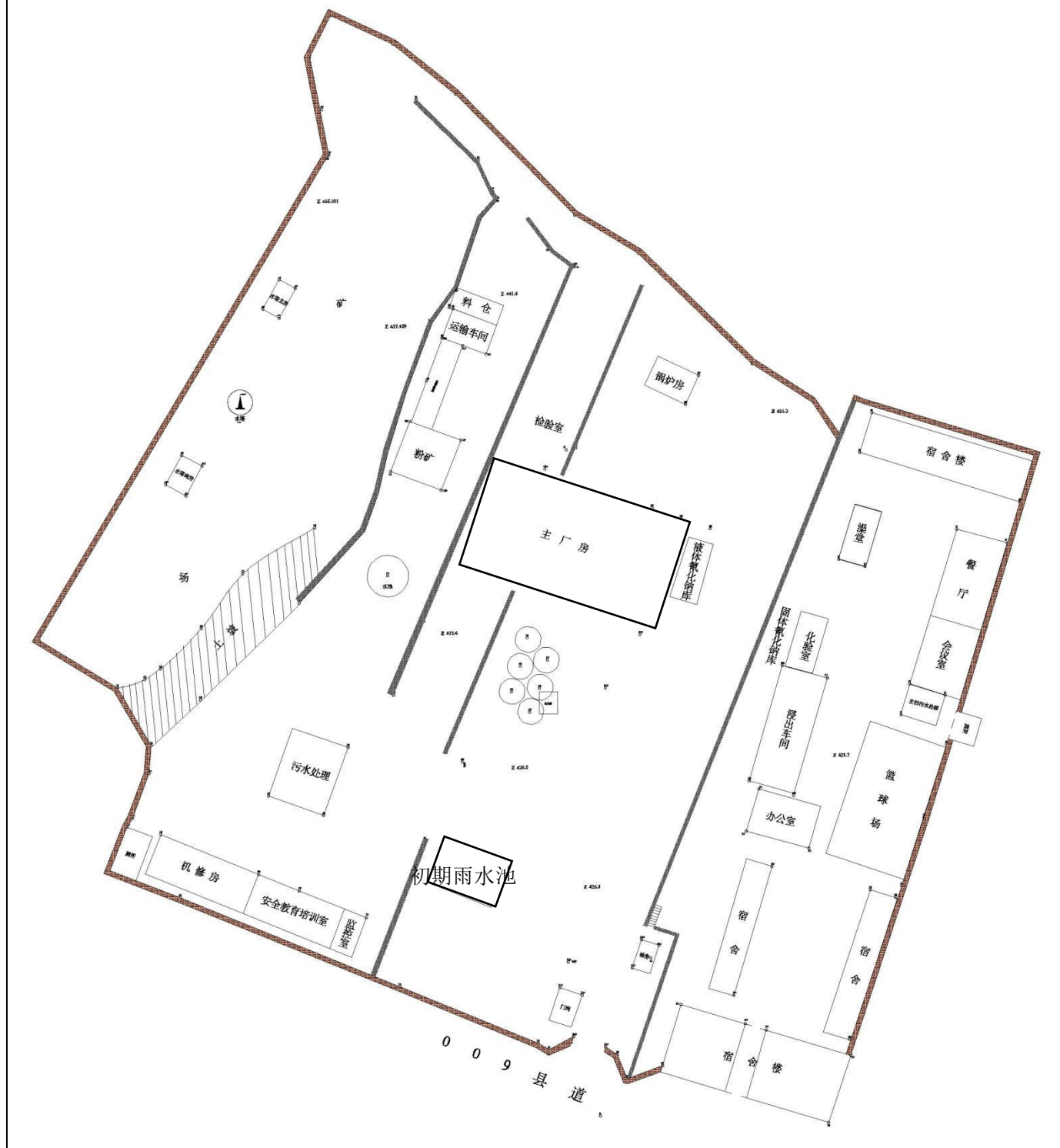
附图 2-1 西阳平选厂平面布置图
