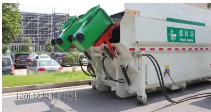
图 3-2 PYZYf 型整体移动式湿垃圾压缩机
