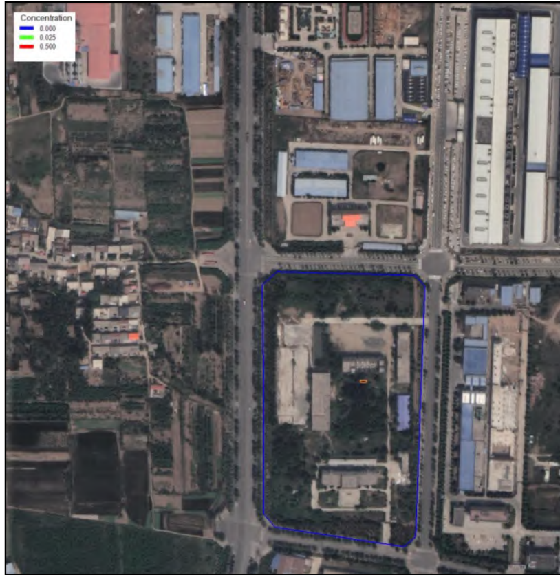
图 5.6-24-1 氨氮瞬时恒定泄露 100d-3650d 时的污染羽图
