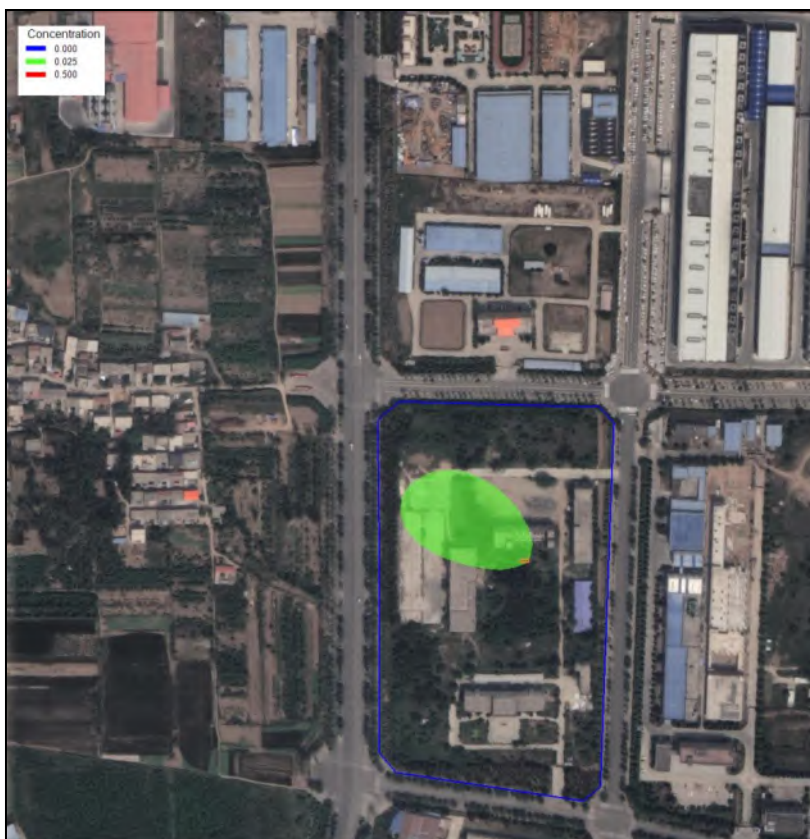
图 5.6-23-2 氨氮连续恒定泄露 1000d 时的污染羽图
