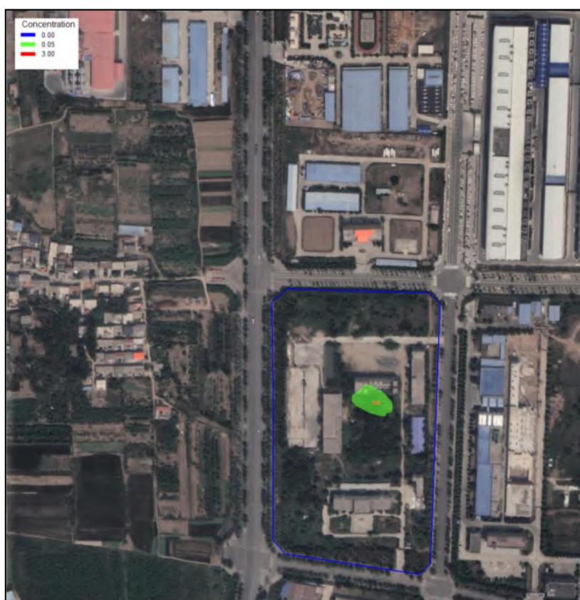
图 5.6-22-1 耗氧量瞬时恒定泄露 100d 时的污染羽图
