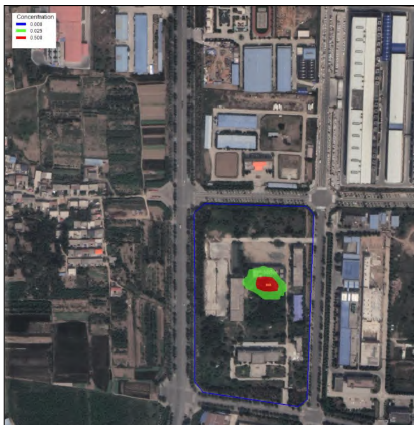
图 5.6-23-1 氨氮连续恒定泄露 100d 时的污染羽图
