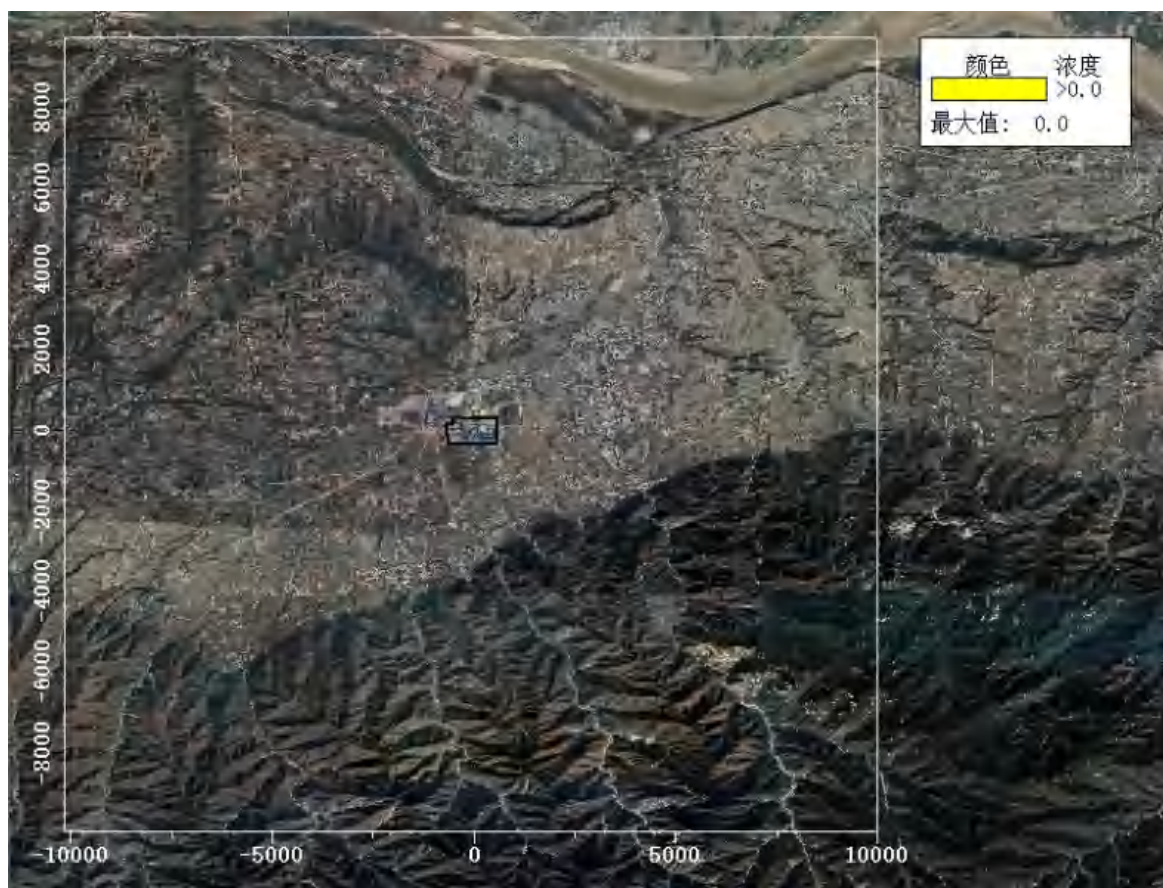
图 6.2-26 区域网格点 Cr 年均地面浓度贡献值等值线图 单位: \mu\text{g}/\text{m}^3
