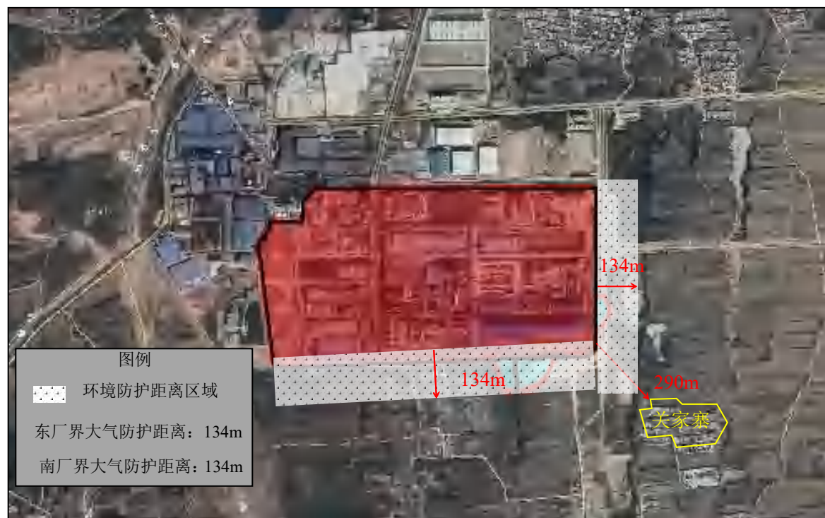
图 6.2-48 本次技改工程完成后大气防护距离图
