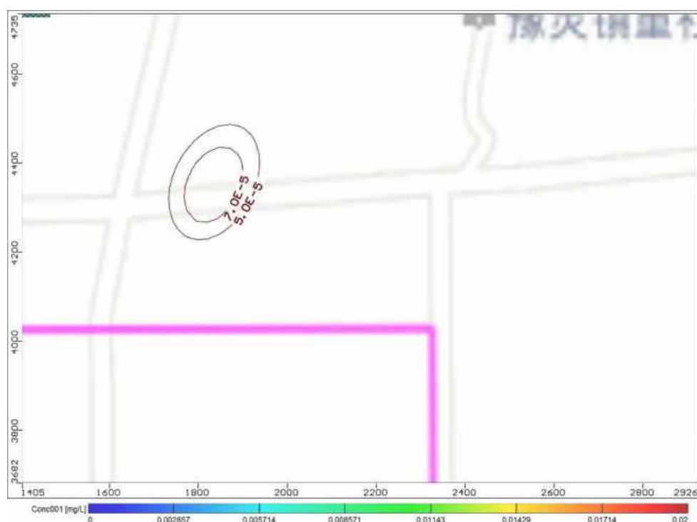
图 6.6-20-2 砷连续恒定泄露 1000d 时的污染羽图
