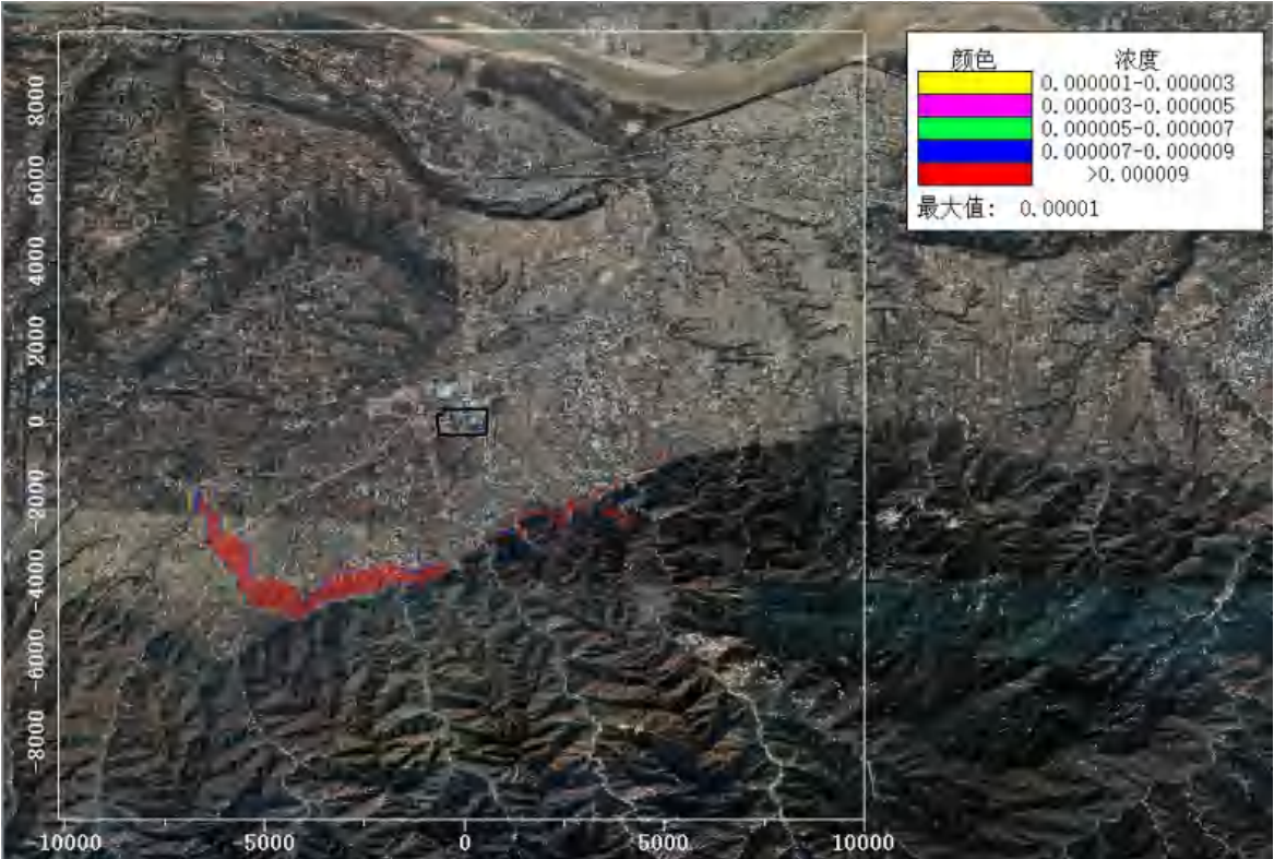
图 6.2-21 区域网格点 Hg 年均地面浓度贡献值等值线图 单位: \mu\text{g}/\text{m}^3
